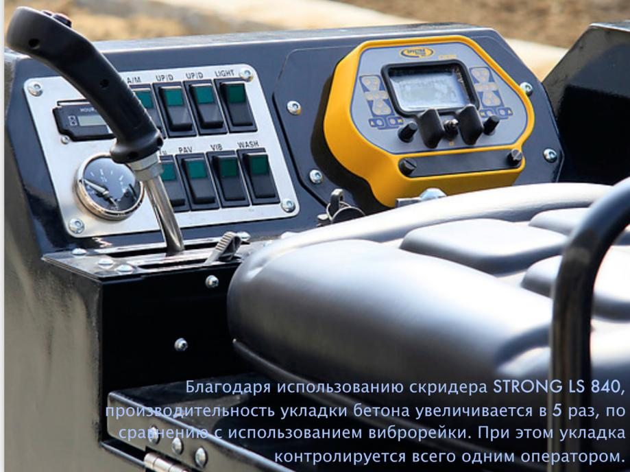
Благодаря использованию скридера STRONG LS 840, производительность укладки бетона увеличивается в 5 раз, по сравнению с использованием виброрейки. При этом укладка контролируется всего одним оператором.
